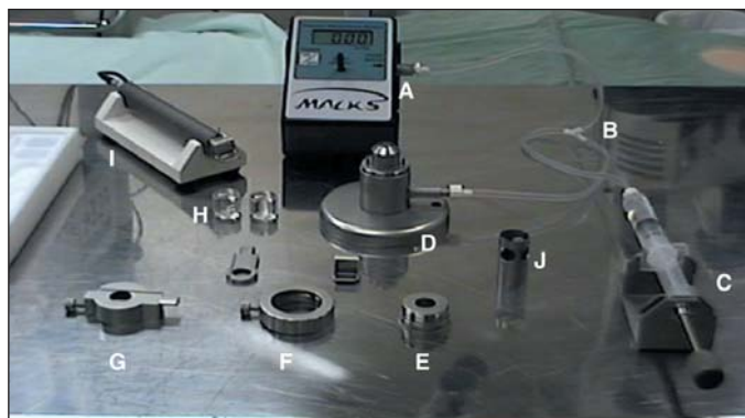
Figura 1 - Componentes do MALKS® e do sistema de infusão. A: Medidor digital da PIC peroperatória; B: Sistema infusão em "Y" (direcionando o líquido infundido, para a câmara e para o medidor digital); C: Suporte para seringa do sistema de infusão, possibilitando o micro-controle da PIC; D: Câmara artificial; E: Anel fixador do botão córneo-escleral; F: Porca de travamento; G: Trilho e ajustador do diâmetro da lamela; H: Aplanadores; I: Microcerátomo Masyk®; J: Trépano marcador
